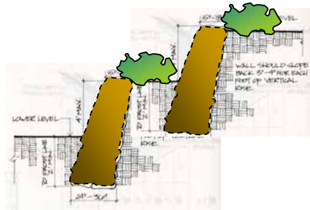
石砌護坡、植被復育
